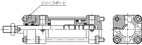
銅系・フッ素系不可エアシリンダ (ブラウン管製造工程対応)
