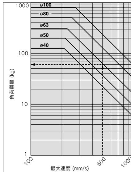
例)φ63のエアシリンダを最大速度500mm/sで動かすときのロッド先端負荷制限を求める。
